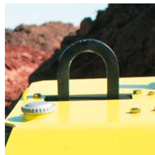
Центально установленный подъемный крюк
