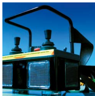
IR передатчик с солнечными батареями
