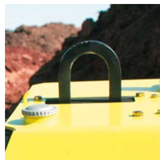
Центрально установленный подъемный крюк
